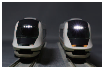
ヘッドライトの光が標識灯まで漏れなくなりました（右）。
