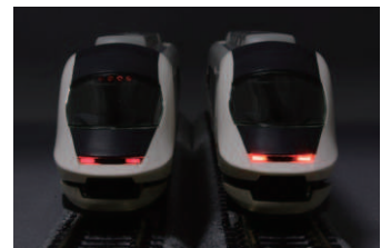
遮光を施したために ヘッドライトにまでテールライトの 光が漏れなくなりました
