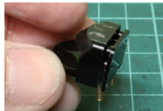
裏フタを外してライト基板と プリズムを取り出します
