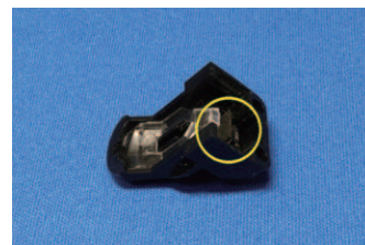
「K-91 遮光紙A」を ヘッドライトと標識灯の プリズムの間に差し込みます
