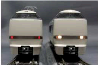
先頭車モード 進行方向に合わせて ライトが切り替わります。
