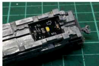
矢印が前になるようにライト基板を 取り付けます
