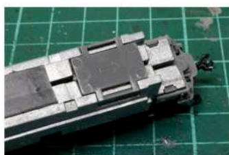
ダイキャストブロック押さえを 取り付けます
