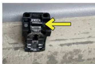
先ほど用意した遮光板を ヘッドライトと標識灯の プリズムの間に差し込みます
