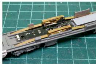
ライト基板と集電シューを 取り付けます ※スイッチ板は使用しません
