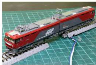
第2車体で集電して第1車体へ通電しています。
